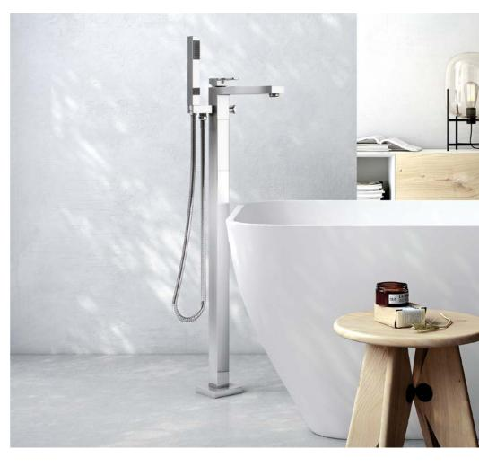
El monomando mezclador de pie para bañera exenta de la Serie Kenjo (Ref.: 63119 26 45 66) incorpora un sistema de regulación para instalar en perpendicular y alineado perfectamente con la bañera. Su cartucho cerámico D40 convencional está provisto de un aireador plástico antical con casquillo de latón cromado. Esta referencia se suministra con conexiones flexibles desde la base hasta el monomando e incluye todos los elementos de fijación.
